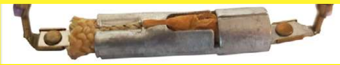
Limitatore di temperatura della coperta di riscaldamento a rottura lenta, utilizzato in combinazione con un sistema di controllo della potenza inglese prodotto da GEC (General Electric Company). È coperto da una guaina impermeabile in PVC, saldata ai fili. Intorno al 1970 (Ultimheat Collection)
