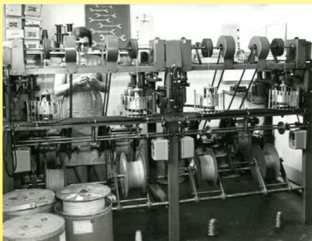
1960 ca. Officina di guipage per i cavi scaldanti utilizzati nelle coperte elettriche. (Ultimatheat Museum)
