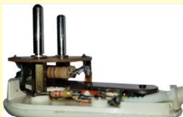
1972 ca. Centralina di controllo della potenza prodotta da Jidé a Limoges con il marchio Jidéstat. Il sistema di maggior successo. Di dimensioni molto ridotte, è regolabile e incorporata nella spina elettrica. È l'unico modello con contatto magnetico a scatto. È stato superato dai sistemi elettromeccanici solo nell'era attuale. (Ultimheat Collection)
