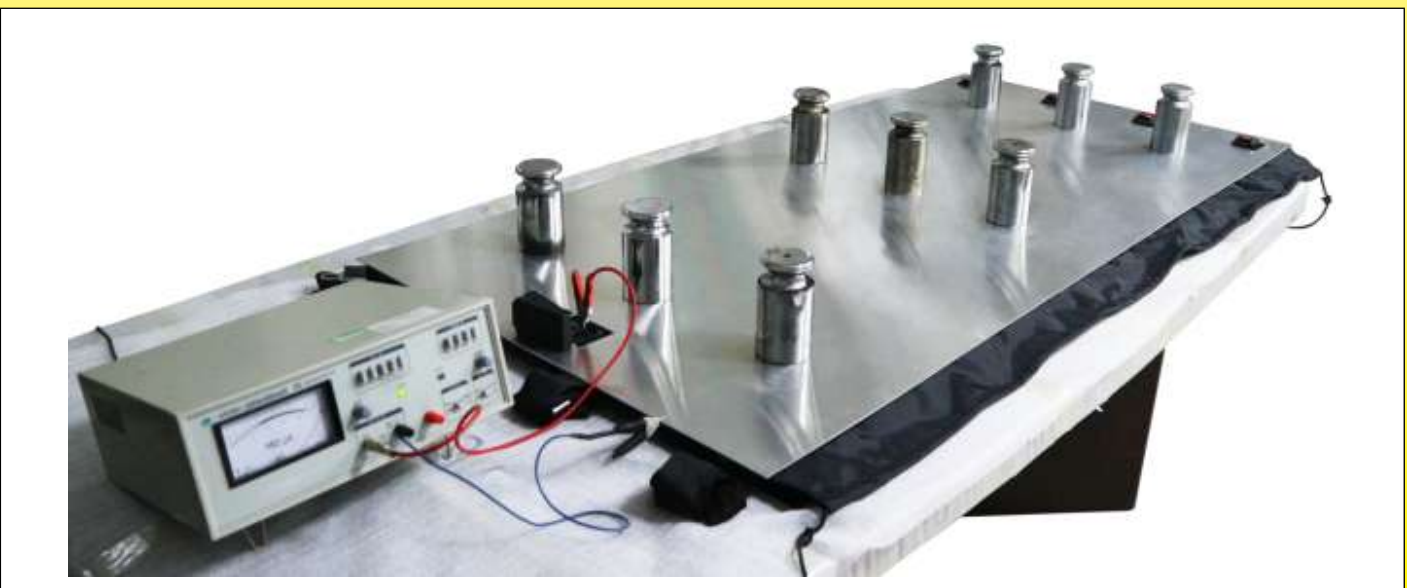
Dispositivo per la misurazione della resistenza di isolamento. I valori misurati sono sempre superiori a 0.1Gohm.
