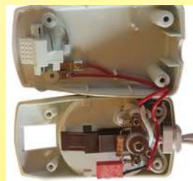
1995: Coperta riscaldante americana a misuratore di potenza, simile a quella sviluppata più di 50 anni prima da Cook nel 1942. Vista esterna e vista del bimetallo interno ha un interruttore lento con resistenza anticipata. L'unico sviluppo degno di nota di questo modello è l'inclusione di un filtro antidisturbo (Ultimheat Collection)
