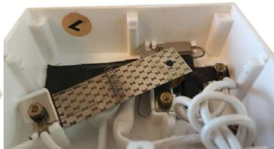
1970 ca. Regolazione della potenza GEC (General Electric, Inghilterra) su una coperta riscaldante inglese. La resistenza anticipata è chiaramente visibile sopra il bimetallo e l'interruttore lento (Ultimheat Collection).
