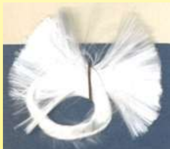
Fasci di filamenti di vetro che formano un unico filo (Fabbricazione di filamenti di vetro, intorno al 1960, lezione della scuola tessile di Verviers in Belgio, Ultimheat Museum)
