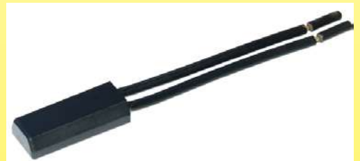
2019 Limitatore di temperatura a scatto per il riscaldamento transitorio, derivato dal modello 7AM della Texas Instruments del 1966, utilizzabile a 230V, in involucro impermeabile in plastica. Intervallo di temperatura da 5 a 8°C. Tipo V7AM. (Ultimheat Collection)
