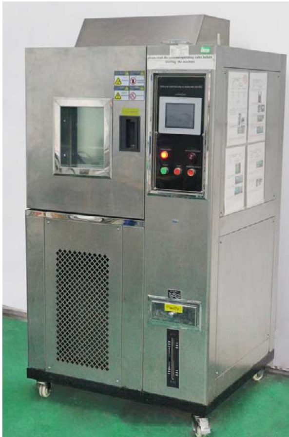
Camera climatica, con intervallo di regolazione della temperatura da -90 a +150^{\circ}C , intervallo di regolazione dell'umidità relativa da 1 a 100%.
