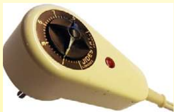
1972 ca. Centralina di controllo della potenza prodotta da Jidé a Limoges con il marchio Jidéstat. Il sistema di maggior successo. Di dimensioni molto ridotte, è regolabile e incorporata nella spina elettrica. È l'unico modello con contatto magnetico a scatto. È stato superato dai sistemi elettromeccanici solo nell'era attuale. (Ultimheat Collection)
