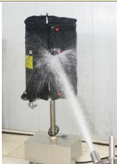
Test IPx6 dei riscaldatori a mantello
